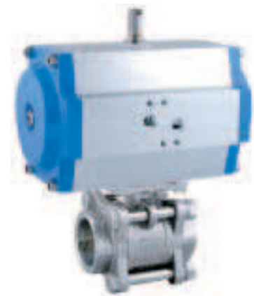
Enkelwerkende RVS driedelige kogelafsluiter - BSP female - NC - veersluitend - aluminium actuator
