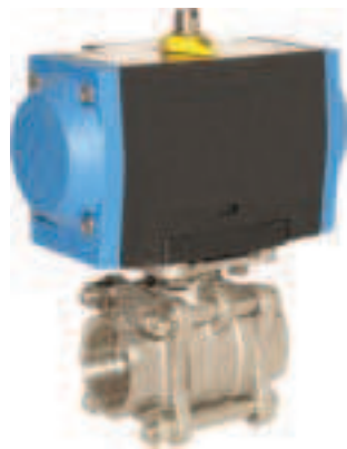
Dubbelwerkende RVS driedelige kogelafsluiter - BSP female - kunststof actuator
