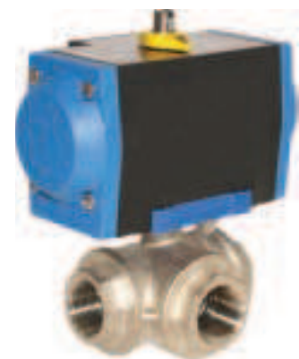
Dubbelwerkende drieweg kogelafsluiter - BSP female - L-boring - kunststof actuator
