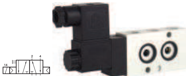
Hafner 5/2 Namur magneetventiel - monostabiel - 1/4" BSP female - met luchtveer - voor dubbelwerkende pneumatisch bediende afsluiters
