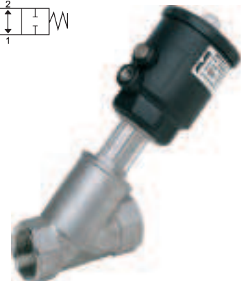
2/2 pneumatisch bediende klepafsluiter - NC - BSP female - RVS AISI-316L - met standindicator
