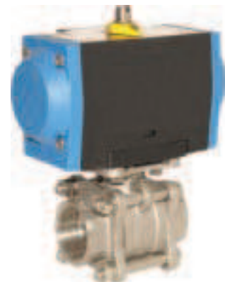
Enkelwerkende RVS driedelige kogelafsluiter - BSP female - NO - veeroopenend - kunststof actuator
